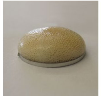
3b. BioFinder biyofilmlerle kontamine bir yüzeyde kullanıldıktan sonra gözlemlenen pozitif tepkimenin yandan görünüşü.
